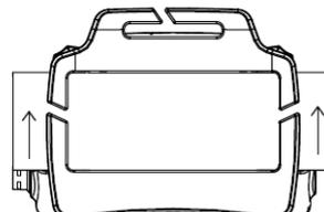
Присоедините наголовное крепление к фонарю, как показано на рисунке: просуньте ремень в отверстие вниз, затем согните ремень и протолкните его в отверстие вверх.
