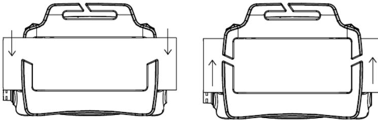
Присоедините наголовное крепление к фонарю, как показано на рисунке: просуньте ремень в отверстие вниз, затем согните ремень и протолкните его в отверстие вверх.
